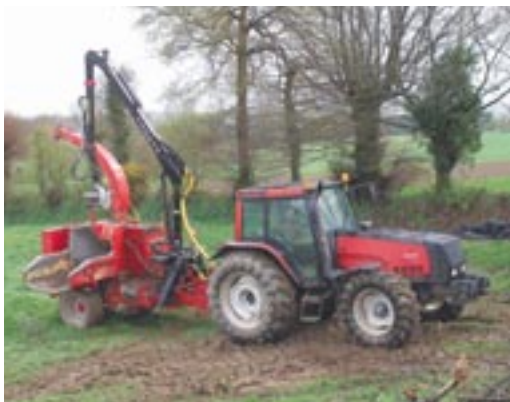
Broyeur pour le bois énergie.
